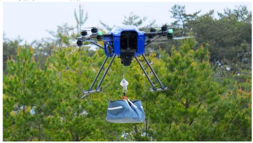
最大30kgの荷物を運搬、着陸せずに荷下ろしするホイスト機構を搭載可能
